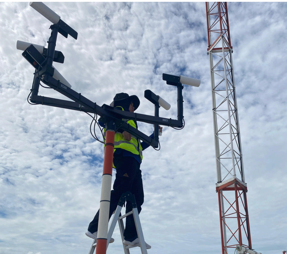
Pemeliharaan Rutin Bulanan AWS Tipe III di Bandara Singkawang demi Memastikan Kualitas Alat dan Data yang Diperoleh
