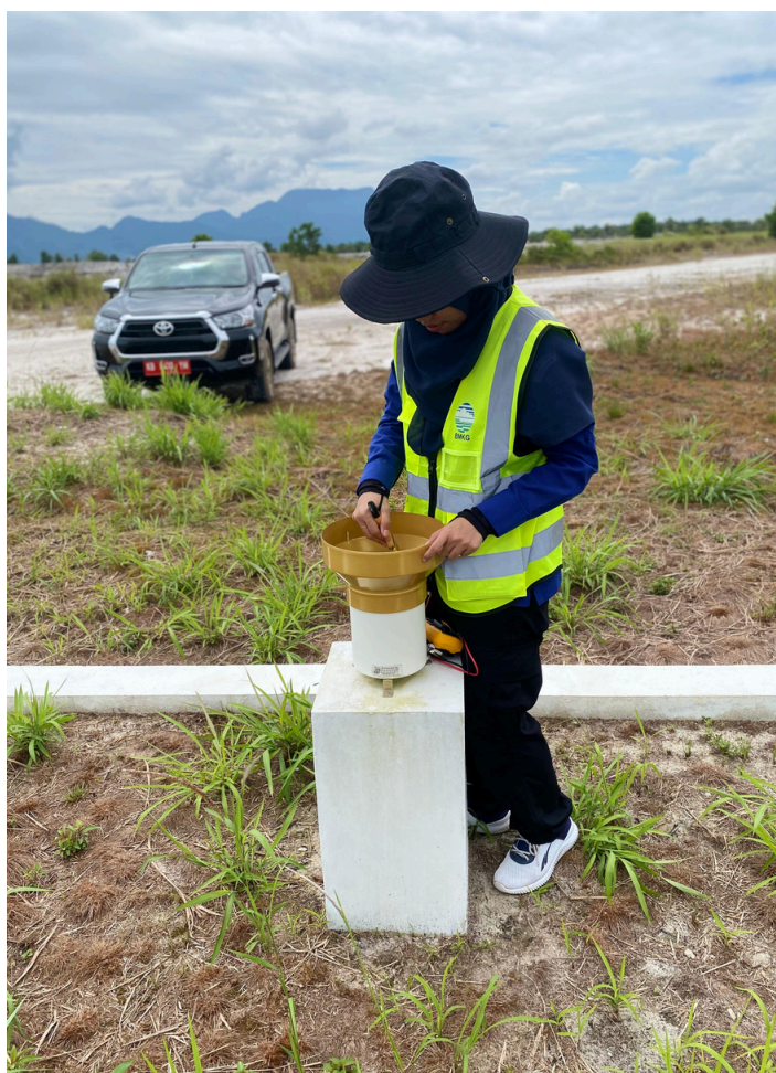
Pemeliharaan Rutin Bulanan AWS Tipe III di Bandara Singkawang demi Memastikan Kualitas Alat dan Data yang Diperoleh
