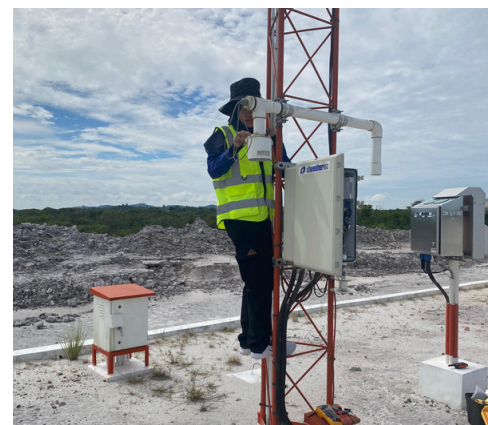
Pemeliharaan Rutin Bulanan AWS Tipe III di Bandara Singkawang demi Memastikan Kualitas Alat dan Data yang Diperoleh
